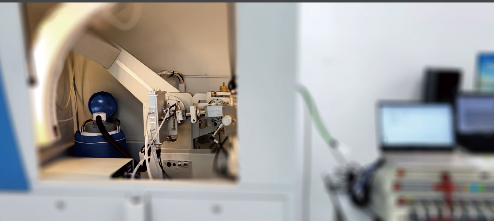
XRD原位冷热台适配理学X-射线衍射仪
